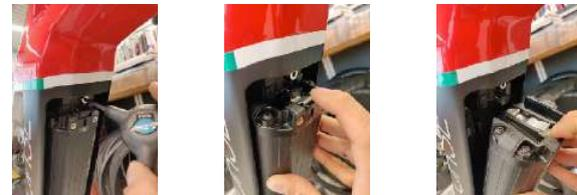
Zum Einsetzen des Akkus die Nut am Akkuboden und die Feder am unteren Teil der Halterung ineinanderfügen, so dass der Akku dort fest verankert ist. Dann den oberen Teil des Akku zum Rahmen hin bewegen, um ihn vollständig am Rahmen zu befestigen.
