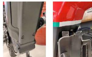
A continuación, inserte una llave de 4 mm en el tornillo de cabeza hueca correspondiente y haga un cuarto de vuelta en el sentido de las agujas del reloj para hacer que baje la batería. Por último, presione hacia abajo la lengüeta cromada con la ayuda de un dedo hasta conseguir extraer por completo la batería.
