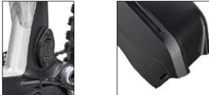
Nach Beendigung des Ladevorgangs sicherstellen, dass die Abdeckung wieder aufgesetzt wird, damit kein Wasser oder Schmutz eindringen kann und die Lebensdauer der Anlage nicht beeinträchtigt wird.
