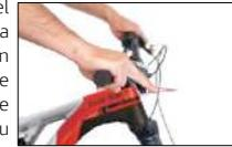
Pruebe los frenos cada vez antes de conducir, si descubre que la función del frenado se está perdiendo aunque sea un poco, sin importar antes o mientras conduce, solicite asistencia en una tienda de bicicletas calificada para ver si se recomienda la pastilla de freno. ser cambiado.
