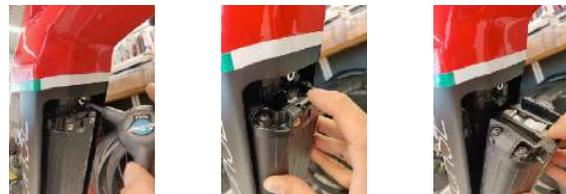
Per installare la batteria: far combaciare la sporgenza del supporto basso con la scanalatura che si trova sul fondo della batteria e, facendo perno sulla base inferiore, accompagnare la parte alta della batteria dentro il telaio in pozione. Inserire le due linguette della cover batteria nelle apposite incanalature e riavvitare le due brugole.
