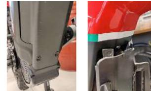
Daraufhin mit einem 4mm-Schlüssel die entsprechende Inbusschraube 90 Grad im Uhrzeigersinn drehen, damit sich der Akku nach unten bewegt. Dann die verchromte Lasche mit einem Finger nach unten drücken und den Akku vollständig abnehmen.
